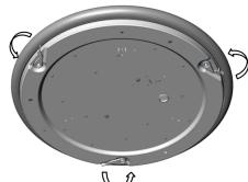
4. Провести мережеві дроти ( $\varnothing$ 6-12 мм) в корпус світильника через гермоізолятор. Корпус зафіксувати на опорній поверхні.
