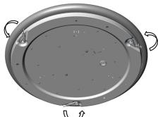
4. Провести сетевые провода ( $\varnothing$ 6-12 мм) в корпус светильника через гермоизолатор. Корпус зафиксировать на опорной поверхности.
