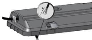
4. Подключить сетевой провод к клеммной колодке на монтажной панели в соответствии с указанной полярностью.
