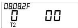
Рисунок 2.16 – Меню 9 кадр 3. Разряд 1 - запрет/разрешение перехода на сезонное время: 0 - переход запрещен; 1 - переход разрешен; разряд 2, 3 - автоматическая коррекция времени (диапазон от минус 19 до 19 ppm)
