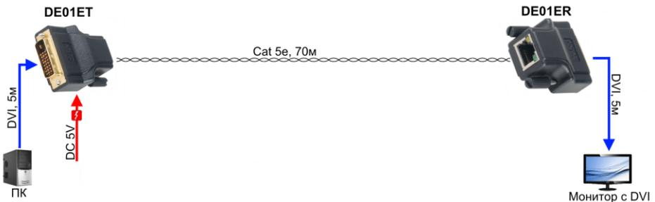
Рис. 5 Схема подключения передатчика DE01ET и приёмника DE01ER.
