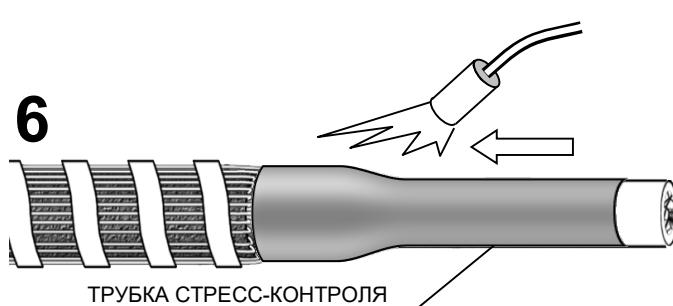
Надвинуть на жилу трубку стресс-контроля до упора в отогнутые медные проволоки экрана. Усадить трубку, начиная от конца жилы по направлению к проволочному экрану.
