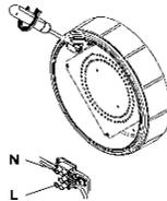
4. Шамдал табанын монтаж бетіне орналастырып, монтажды бетінде алдын ала керек қуыстарды дайындап, пластик тығырықтар арқылы сәйкес келетін тіреуіштердің (диаметр 3.5 мм аспайтын) көмегімен бекітіп қойыңыз.
