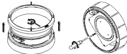
3. Через один з гермопроводов завести в основу світильника мережевий кабель круглого перетину, зафіксувати його кабельним зажимом, та підключити до конектора.
