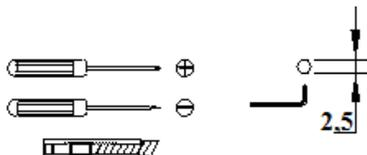
2. Снять верхнюю часть светильника и рассеиватель, используя шестигранный ключ №2,5.
