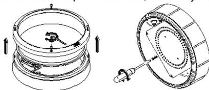
3. Через один из гермопроводов завести в основание светильника сетевую кабель круглого сечения, зафиксировать его кабельным зажимом, и подключить к коннектору.
