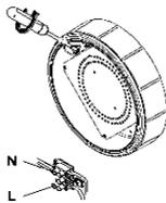
4. Прикласти підставу світильника до монтажної поверхні та зафіксувати його за допомогою відповідного кріплення (діаметр не більше 3,5 мм) через пластикові шайби, попередньо підготувавши необхідні отвори в монтажній поверхні.
