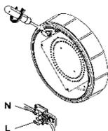
4. Приложить основание светильника к монтажной поверхности и зафиксировать его при помощи подходящего крепежа (диаметр не более 3,5мм) через пластиковые шайбы, предварительно подготовив необходимые отверстия в монтажной поверхности.
