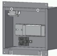
4. Підключити мережевий провід до клемної колодки, відповідно до зазначененої полярності.
