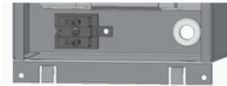
3. У заздалегідь підготовленої ніші закріпiti світильник 4 гвинтами до стіни.
