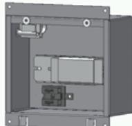
4. Подключить сетевой провод к клеммной колодке, в соответствии с указанной полярностью.
