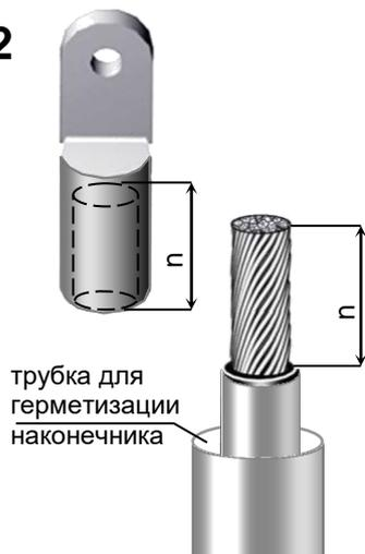
Надеть на каждую жилу трубку для герметизации наконечника. С каждой жилы снять фазную изоляцию на длине равной длине трубчатой части наконечника «п». Обезжирить жилу и внутреннюю часть наконечника и опрессовать. Указание по обжиму наконечников прилагается.
