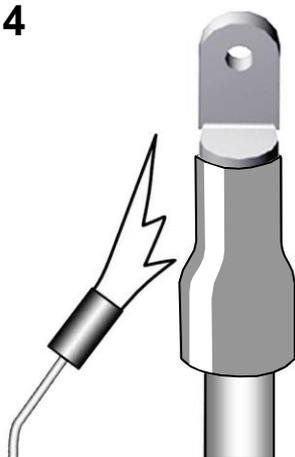
Надвинуть на цилиндрическую часть наконечника трубку ТТнг для герметизации наконечника и усадить ее.
