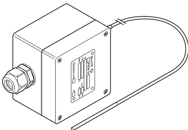
3-проводной датчик nVent RAYCHEM Pt100 с соединительной коробкой из армированного стекловолокном полиэфира с четырьмя пружинными клеммами. Комплектуется кабельным сальником M20 EEx e, предназначенным для использования во взрывоопасных зонах.
