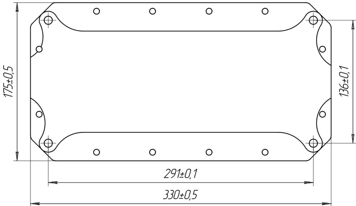
**Рис.3 Разметка крепления и габаритные размеры.**
