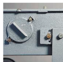
Узел замены лампы и шкала установки угла
