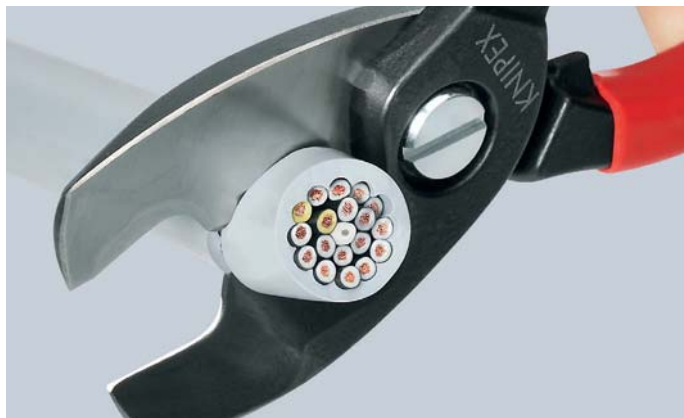
Вторичный рез: если требуется большее усилие (при резке проводов), возможна установка кабеля в профиль в режущих кромках у шарнира. Первичный рез — в переднем профиле, вторичный рез — в заднем
