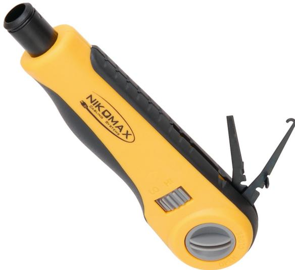
Ударные инструменты NMC-3640R и NMC-3640RB предназначены для заделки кабеля в кроссы, патч-панели, розетки и модули. Инструменты совместимы с ножами с байонетным креплением типа Twist-Lock. В зависимости от установленного ножа, могут использоваться для заделки контактов 66-го, 88-го, 110-го типа или оборудования типа KRONE. Инструмент NMC-3640RB поставляется с ножом NMC-14TA (66/88/110) в комплекте. Ножи для инструмента NMC-3640R приобретаются отдельно.
