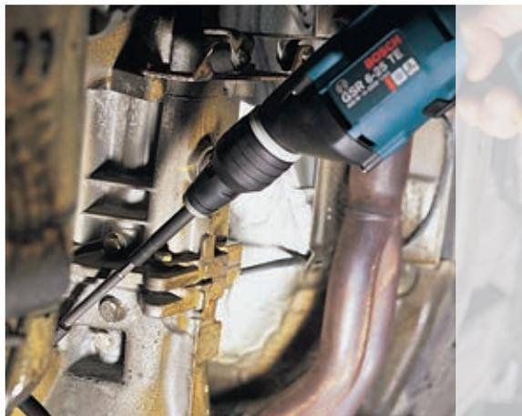
Закрепленный в рукоятке: шурупы с наружным шестигранником вворачиваются с помощью торцовых ключей Bosch в одно мгновение.
