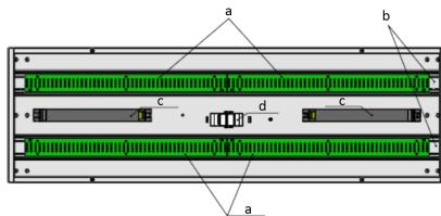
6. Для модифікації Olympic LED80 налаштувати необхідний кут встановлення світильника (20, 40 град.) шляхом поєднання технологічних отворів в кронштейнах і фіксації гвинтами M5.
