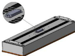
4. Поєднати отвори у кронштейнах на корпусі з отворами у стельових кронштейнах використовуючи гвинти M5 (входять до комплекту поставки).
