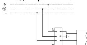
2. Схема підключення світильника до мережі живлення з регульованим драйвером по системі DALI .
