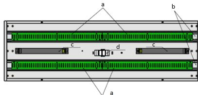
6. Для модификации Olympic LED80 настроить требуемый угол установки светильника (20, 40 град.) путём совмещения технологических отверстий в кронштейнах и фиксации винтами M5.
