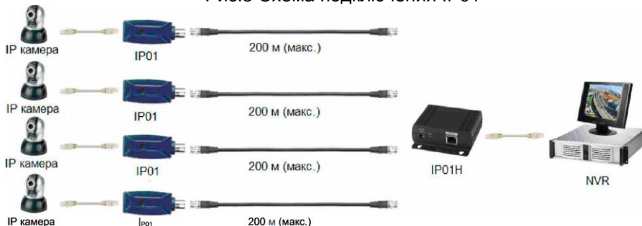
Рис.5 Схема подключения IP01
