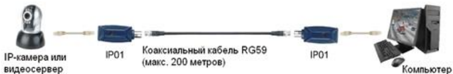
Рис.5 Схема подключения IP01
