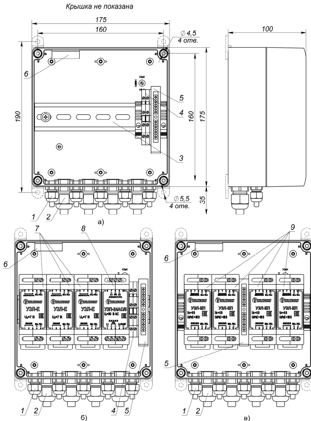
Рис.1 Устройство, габаритные и установочные размеры КМ-8 (а), КМ-8 исп.1 (б), КМ-8 исп.2 (в)
