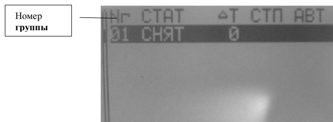
Рис.3 Меню Дистанционное управление группой (выделенная строка указывает на выбранное направление – группу 1)
