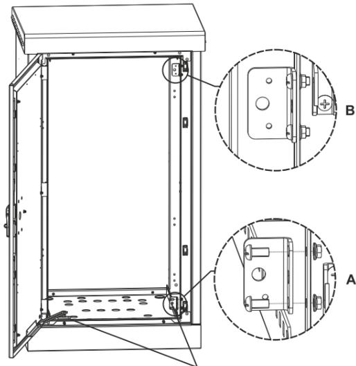
Для блокировки двери применить один уголок из комплекта поставки и один уголок демонтировать с ограничителя двери (уголки одинаковые).
