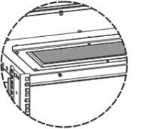
Предусмотрена установка модуля вентиляторного потолочного по ТУ РБ 800008148.004-2005 в крышу или дверь шкафа. Установите модуль и зафиксируйте четырьмя винтами М5.
