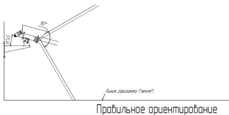
Рисунок 4 — Ориентирование изделия относительно горизонта
