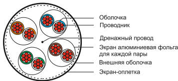
Рисунок 6 – Конструкция патч-корда категории 6d типа S/FTP
