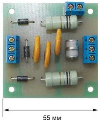
Блоки АЛЬБАТРОС-24/70-DC и АЛЬБАТРОС-24/70-AC **обеспечивает защиту нагрузки** мощностью 70 Вт от высоковольтных импульсов до 10 кВ и аварийного повышения напряжения в сетях с номинальным постоянным или переменным напряжением 24 В.
