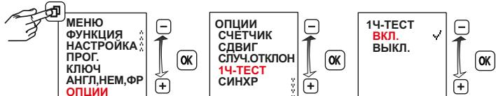
По истечении одного часа таймер возвращается в положение, контролируемое действующей программой.
