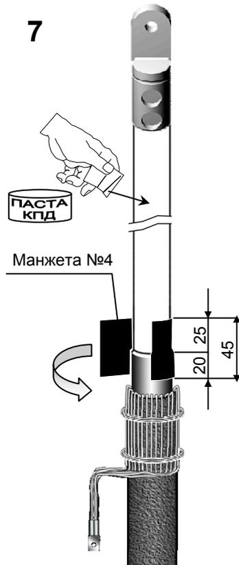
На переход (электропроводящий экран-полиэтиленовая изоляция кабеля) наложить манжету № 4 (из пакета 1ПКВ(Н)т35) черного цвета на срез электропроводящего слоя, длинной стороной по окружности кабеля с заходом на электропроводящий экран на 20 мм и на полиэтиленовую изоляцию на 25 мм, обжать рукой.
