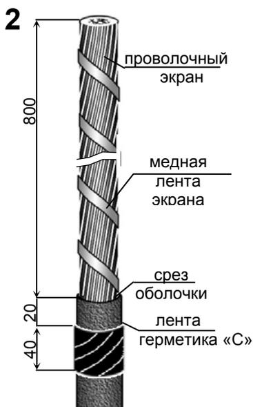
Отогнуть медную ленту экрана и аккуратно отрезать ее по линии среза оболочки кабеля.
