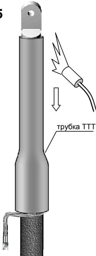
Надвинуть на конец кабеля трекингостойкую трубку (ТТТ) так, чтобы верхний конец её совпадал с краем цилиндрической части наконечника и усадить её, начиная с цилиндрической части наконечника.
