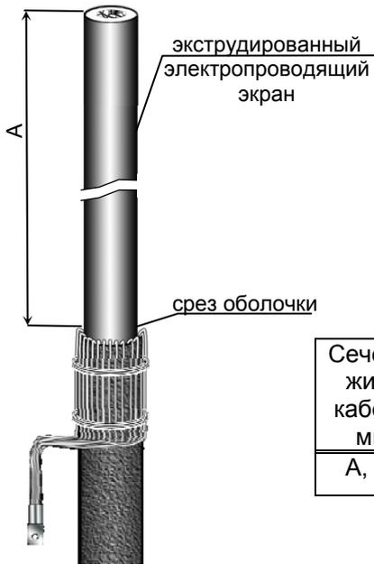
Размотать электропроводящую бумагу до среза оболочки, и аккуратно обрезать её **не повреждая электропроводящего экрана**. Обрезать жилу кабеля на расстоянии А от места среза оболочки.
