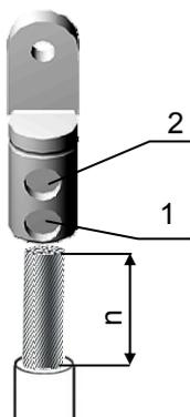
Снять изоляцию с жилы кабеля на расстоянии n равном внутренней длине цилиндрической части наконечника
