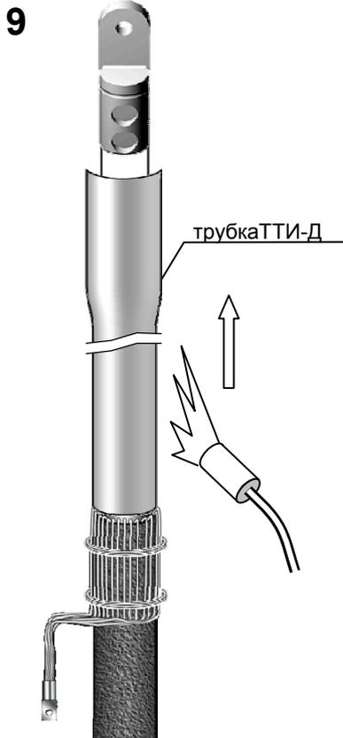
Надвинуть изолирующую трубку ТТИ-Д на жилу кабеля до среза оболочки и усадить. Усадку производить от среза оболочки к концу жилы.
