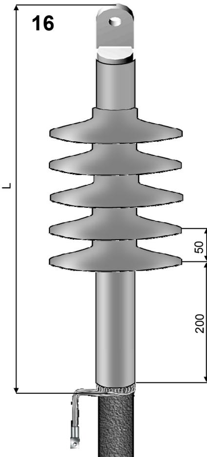
После усадки трекингостойкой трубки на неё надеть и усадить пять термоусаживаемых «юбок» изоляторов, начиная снизу и на расстояниях, указанных на рисунке.
