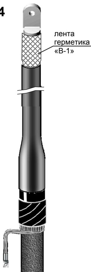
Цилиндрическую часть наконечника и прилегающую часть изоляции жилы на длине 20 мм обезжирить и обмотать лентой герметика «В-1».
