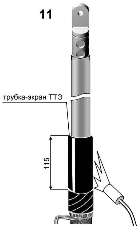
Надвинуть на конец кабеля трубку-экран ТТЭ и расположить ее так, чтобы нижний конец трубки закрывал медные проволоки отогнутого экрана на длине 20 мм и упирался в край герметика «С». Усадить трубку-экран слабым пламенем горелки, начиная с нижнего конца.
