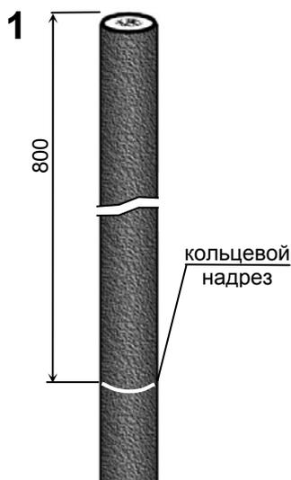
Распрямить конец кабеля на длине 1000 мм. На расстоянии 800 мм от конца кабеля выполнить кольцевой надрез по оболочке кабеля с помощью льняной нити.
