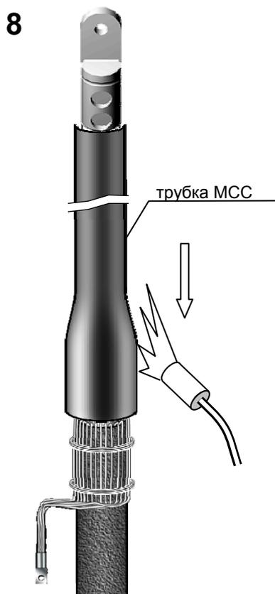
Надвинуть на жилу первую трубку МСС стресс-контроля меньшего диаметра до упора в отогнутые проволоки медного экрана.
