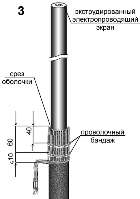
Отогнуть проволоки экрана кабеля на оболочку кабеля так, чтобы они не пересекались между собой, вдавив каждую в подмотку герметика «С». Проволоки экрана отгибать «с натягом», чтобы они плотно облегли срез оболочки кабеля.
