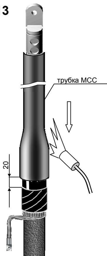
Надвинуть на жилу вторую трубку МСС стресс-контроля большего диаметра так, чтобы ее нижний край находился на расстоянии 20 мм от верхнего края подмотки герметиком «С».
