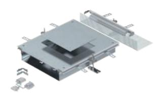
Монтажная секция кабельного канала ОКА с крышкой для установки лючков и кассетных рамок состоит из основания кабельного канала (закрытого корпуса с боковыми и стыковочными профилями), крышки канала с закрытым монтажным отверстием и торцевой заглушки. В комплект входят 3 регулируемых крепежных уголка, 3 анкера для стяжки, 1 опора крышки и 1 комплект для ответвления.
