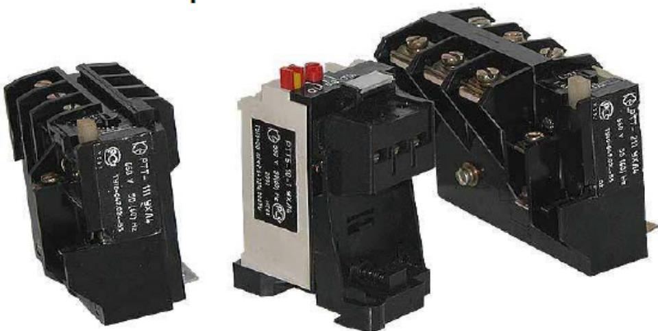
Реле предназначены для защиты трехфазных асинхронных электродвигателей с короткозамкнутым ротором от токовых перегрузок недопустимой продолжительности, в том числе возникающих при выпадении одной из фаз.
