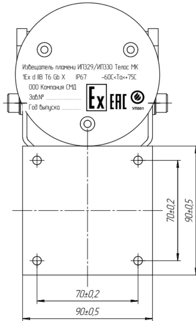
**Рис.А.3. Установочные размеры извещателя пламени «Телос» МК.**
