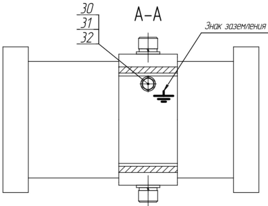
**Рис.А.4. Внешний зажим заземления**
