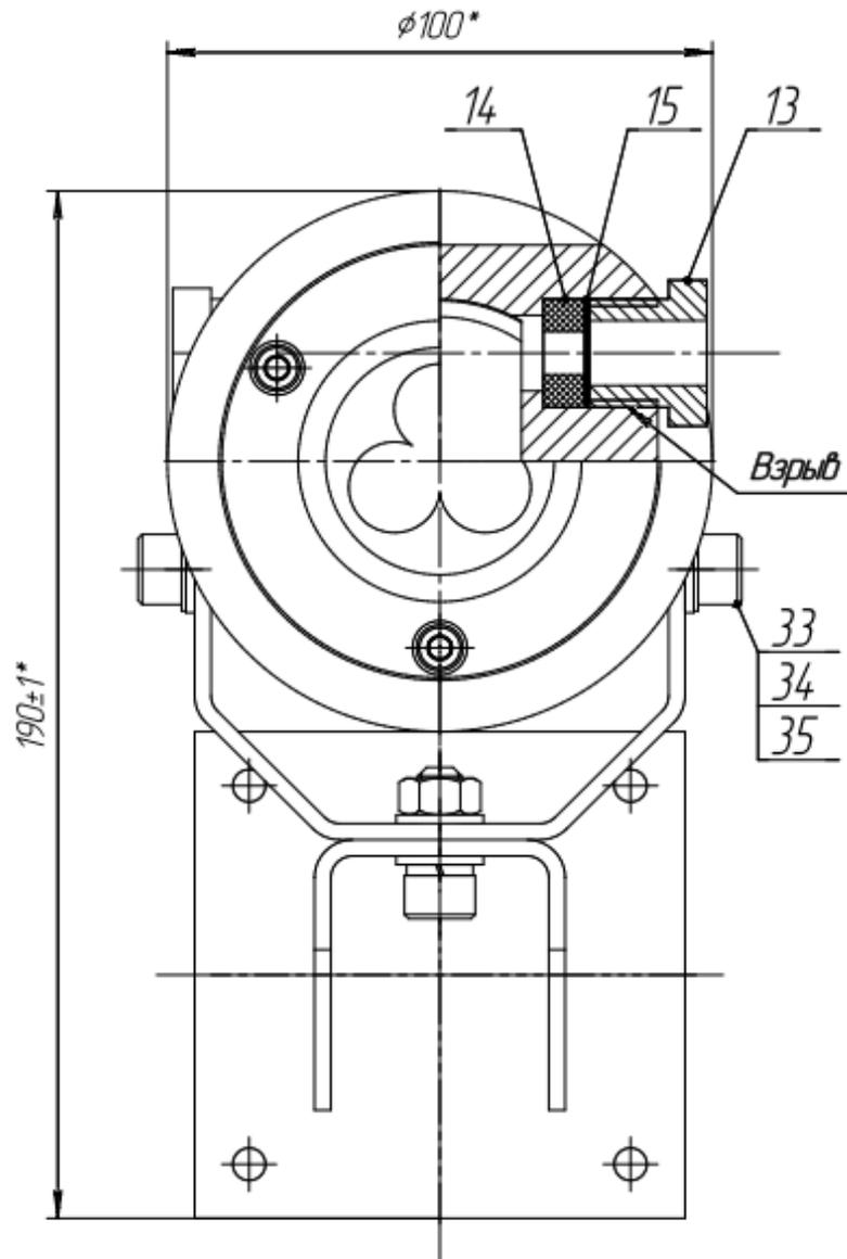
13 – кабельный ввод; 14 – кольцо уплотнительное кабельного ввода; 15 – шайба кабельного ввода; 33 – винты наклонно – поворотного механизма кронштейна.
