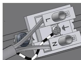
10. При выстраивании линии, сетевой провод подключается к коннектору первого светильника (следует учитывать максимально возможное число светильников в линии). Далее клеммные колодки светильников соединяются между собой отрезками кабеля, соблюдая полярность.
