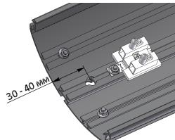
4. Установить систему подвесов на необходимом расстоянии друг от друга. Минимальное необходимое число подвесов при установке в линию  $n = N + 1$ , где  $n$  – число подвесов,  $N$  – число светильников в линии (по одному подвесу в стыковочных узлах замкнутого контура).
