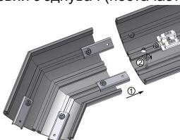
8. Одягти світильник на підготовлені підвіси. Наступний світильник, із закріпленими на ньому кріпильними планками або кутовим алюмінієвим соединителем, з'єднати з уже підвішеним, вибудовуючи, таким чином, лінію з корпусів.
