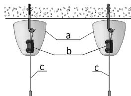
6. Установка непосредственно на опорную поверхность ( на рис. а - втулка, б - ползунок).
