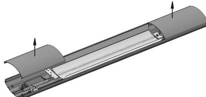
2. Во избежание усадки в процессе эксплуатации цветной декоративной полимерной вставки, необходимо при сборке линии вытянуть вставку из паза на длину ~100-150 мм и аккуратно заправить в паз начиная с торца светильника. Обрезка вставки не допускается.
