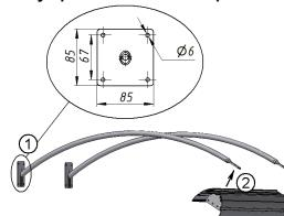
13.2. Установить кронштейны на опорную поверхность.
