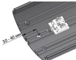
4. Встановити систему підвісів на необхідній відстані один від одного. Мінімальна необхідна кількість підвісів при установці в лінію  $n = N + 1$ , де  $n$  - число підвісів,  $N$  - число світильників в лінії (по одному підвісу в стикувальних вузлах замкнутого контуру).
