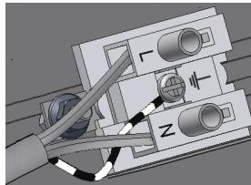
10. При вибудуванні лінії, мережевий провід підключається до конектора першого світильника (слід враховувати максимально можливе число світильників в лінії). Далі клемні колодки світильників з'єднуються між собою відрізками кабелю, дотримуючись полярності.
