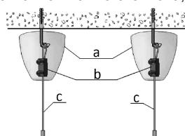
6. Установка безпосередньо на опорну поверхню (на мал. а - втулка, б - повзунок).
