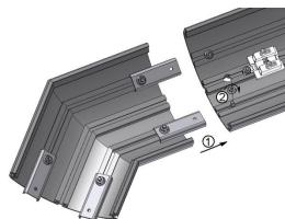
8. Надеть светильник на подготовленные подвесы. Следующий светильник, с закрепленными на нем крепежными планками или угловым алюминиевым соединителем, соединить с уже подвешенным, выстраивая, таким образом, линию из корпусов.
