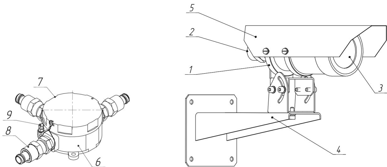
1 Корпус; 2 кабельный ввод с постоянно – присоединенным кабелем; 3 окно пропускающее ИК-излучение; 4 кронштейн с юстировочным устройством; 5 защитный козырек; 6 коммутационная коробка; 7 крышка; 8 кабельный ввод для внешних подключений; 9 зажим заземления.
