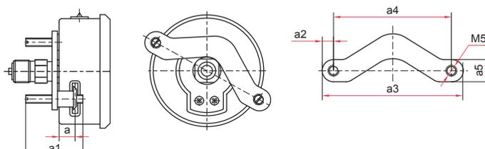
Осевое присоединение со скобой тип 2 (Ø63 мм)
