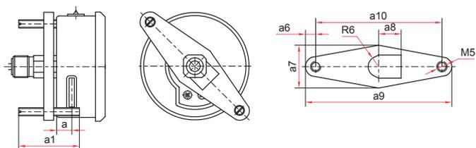
Осевое присоединение со скобой тип 1 (Ø63 мм)
