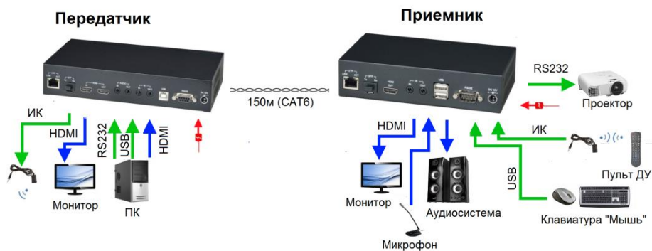
Рис. 9 Подключение передатчиков и приемников «точка-точка».
