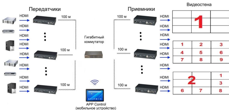
Рис. 15 Подключение передатчиков и приемников по гигабитной сети для создания видеостен.
