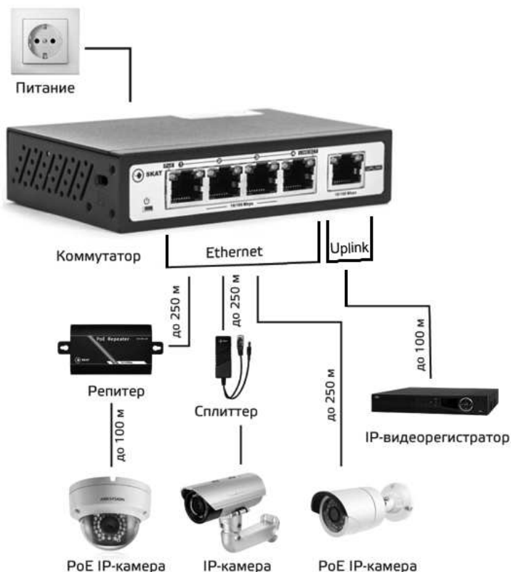
Рисунок 3 – Общая схема подключения устройств к коммутатору
