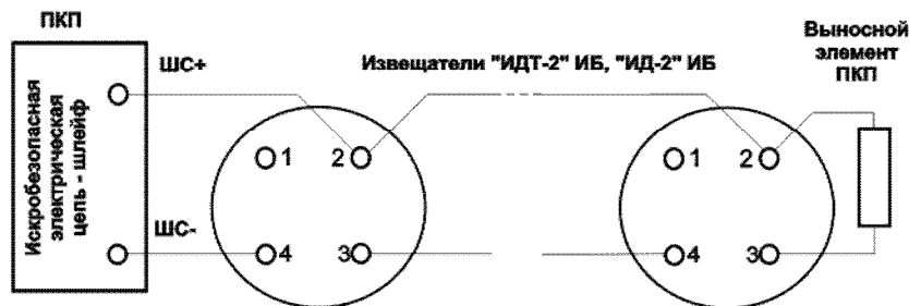
Рисунок 2 - Типовая схема включения извещателя
