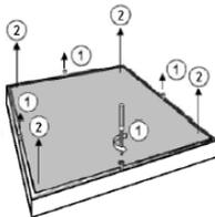
2. Гермоизолятор арқылы желілік сымдарын өткізіңіз, бұл шамшырақ корпусының тығыз тесігіне орнатылады (гермоизолятор жеткізілім жийынтығына кіреді )
