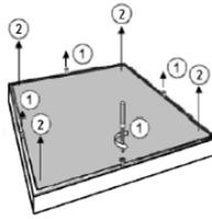
2. Провести мережеві дроти через гермоізолятор, який вставляється в ущільнюваний отвір корпусу (гермоізолятор входить до комплекту поставки) світильника.
