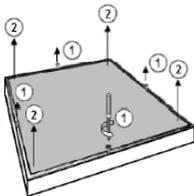
2. Провести сетевые провода через гермоизолятор, который вставляется в уплотняемое отверстие корпуса (гермоизолятор входит в комплект поставки) светильника.
