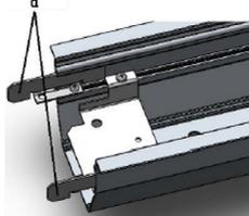
4. Шамшырақты арқанға іліп, оның шеттерін грипเปอร์ге (өзіқысатын ұстағыш) қондыру.
