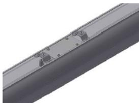
6. Скрепить светильники между собой стяжкой (сдвинув светильник вплотную к предыдущему) внутри корпуса.
