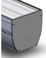
3. Бекіткіш пластиналарды шамшырақтың жанындағы ойыққа жалғау (а-пластинасы).
