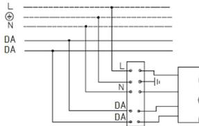
2. Схема підключення світильника до мережі живлення з регульованим драйвером та модулем ME6-NF.
