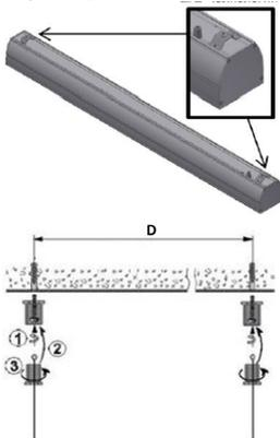
5. Вставить в пазы и прикрутить соединительную пластину сверху корпуса (для установки светильника в линию).
