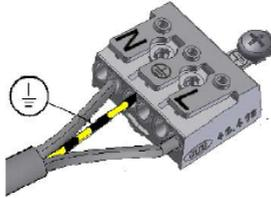
8. При використанні регульованого драйвера, керуючі дроти підключаються строго з дотриманням полярності, зазначеної у маркуванні.
