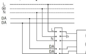
2. ME6-NF модулі бар және реттелетін драйвері бар қоректендіруші желіге шамшырақты қосу схемасы.
