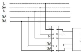
2. Схема подключения светильника к питающей сети с регулируемым драйвером и модулем ME6-NF.
