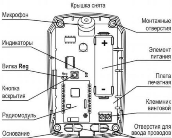
Вилка **Reg** служит для включения на извещателе режима регистрации в радиосети. Для этого выполняется кратковременное замыкание вилки (на 1 - 2 с) с последующим нажатием кнопки вскрытия (ТМП). Режим будет включен на время 60 с от момента замыкания вилки. При нормальной работе в радиосети режим регистрации не включается без специальных мер (см. раздел **Настройка системы Астра-Зитадель**)
