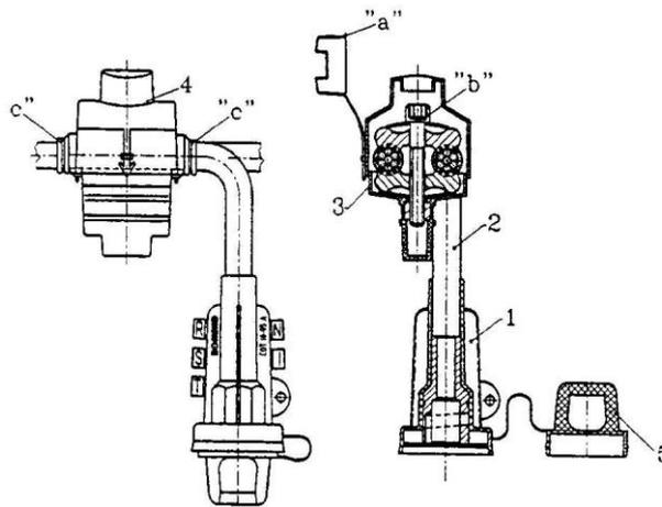
1 - разъем-адаптер, 2 - медный изолированный проводник, 3 - провод СИП, 4 – зажим прокалывающий, 5 - колпачок
