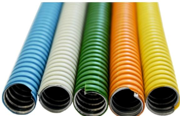
Металлорукав типа МРПИ нг - негерметичный металлорукав в ПВХ изоляции, изготовленный из металлической оцинкованной ленты, предназначен для механической защиты электрических или информационных кабелей в трубных системах прокладки кабеля повышенной гибкости.
