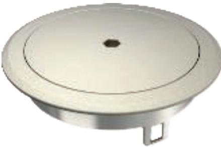
Глухая крышка с внутренним шестигранным ключом для лючка GES R2 для монтажа в монтажной коробке MT R2. Крышка может использоваться в качестве вывода для кабеля. В закрытом состоянии лючок соответствует требованиям стандарта EN 50085-2-2.
