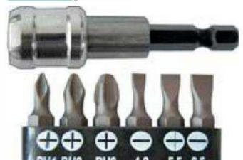
WP. Профи. В наборе: адаптер для бит с магнитным фиксатором и дополнительным шарнирным механизмом прочного крепления биты + 6 бит длиной 25 мм (SL4; SL5.5; SL6.5; PH1; PH2; PH3) с насечками, сталь S2, в пластиковом картридже. Упаковка: блистер.
