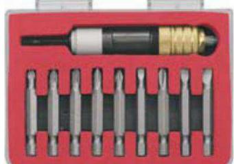
В наборе: магнитный адаптер для бит длиной 50 мм для закручивания шурупов на заданную глубину при производстве гипрочных работ, сборке упаковки; 9 бит (L=50 мм): SL4, SL5, SL6, PH1, PH2, PH3, PZ1, PZ2, PZ3. Материал: биты и механизм расцепления – сталь S2, ограничитель глубины из алюминия, держатель из инструментальной стали, хвостовик из хром-ванадиевой стали. Упаковка: пластиковая коробка в блистере.
