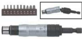
Универсальный адаптер для бит с шариковым креплением биты и дополнительный шарнирный механизм для работы под углом до 20°. В наборе: универсальный адаптер, 10 бит (25 мм) в пластиковом картридже (PH1, PH2, PH3, T10, T15, T20, T25, T27, T30, T40). Материал: биты – сталь S2, держатель и хвостовик из хром-ванадиевой стали, алюминиевая фиксирующая муфта. Упаковка: блистер.
