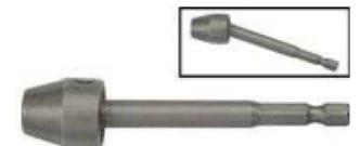
Для работы с шурупами и болтами с шестигранной головкой. С шарнирным соединением хвостовика, позволяющим работать под углом до 30°. Материал: хвостовик из хром-ванадиевой стали, головка из инструментальной стали. Упаковка: блистер.
