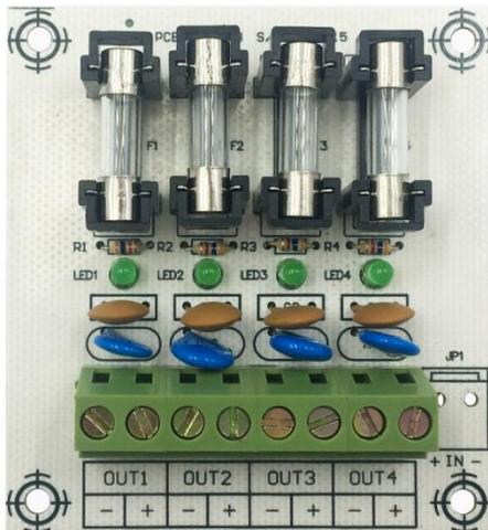
Модуль на 4 выходных канала ST-PS104FB предназначен для расширения базового функционала источников питания ST-PS103, ST-PS105, ST-PS103B-BK, ST-PS105C-BK, ST-PS105D-BK и ST-PS110E-BK. Устройство позволяет получить 4 выходных канала, каждый из которых защищен отдельным предохранителем.
