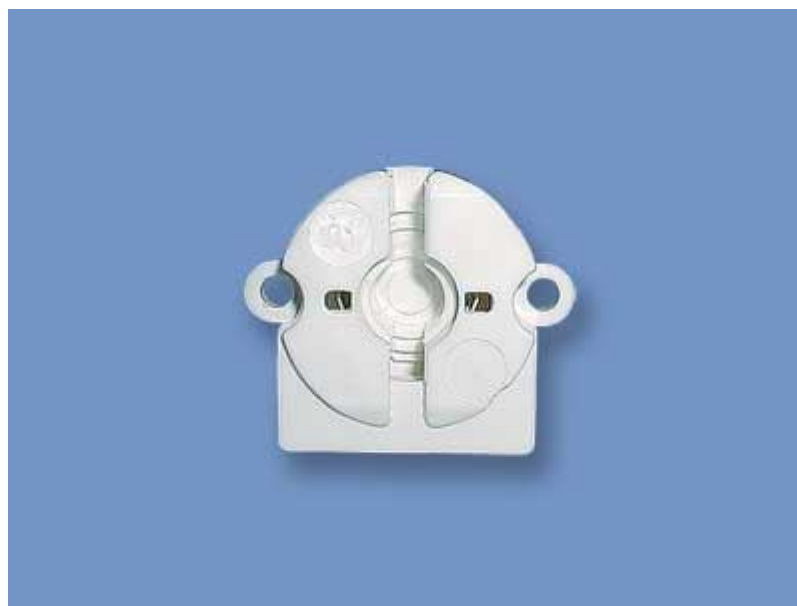
Патрон (ламподержатель) G13 торцевой, встраиваемый, w 9,4mm, для люминесцентной лампы T8, крепление на винт (акс.угловой кронштейн 15.013)
