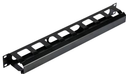
Кабельные органайзеры предназначены для укладки избыточной длины коммутационных или аппаратных шнуров, что позволяет упорядочить их размещение, избежать петель, а также обеспечить хорошую видимость элементов маркировки. Следствием этого является надежность системы и простота ее обслуживания.
