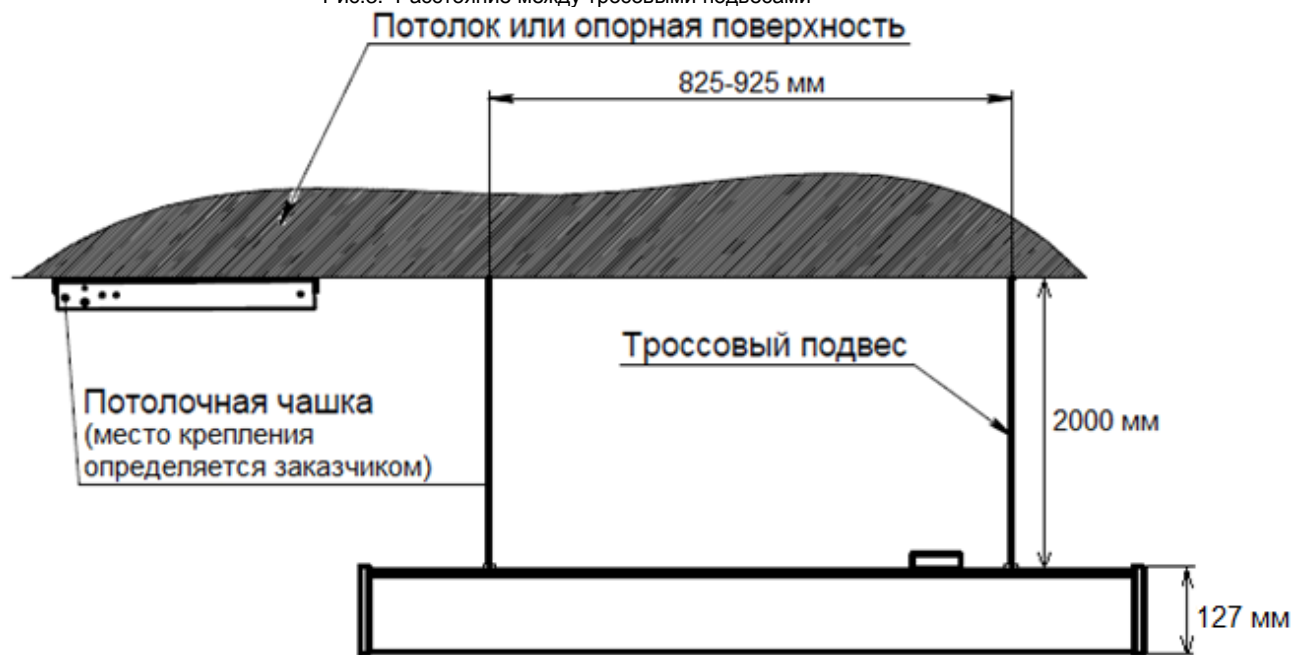
Рис.3. Расстояние между тросовыми подвесами
