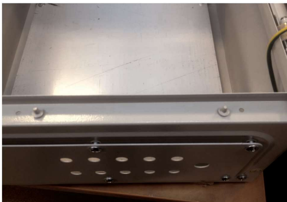
Рис.3.1.2-2 Резиновые заглушки вынуты из отверстий OS.
