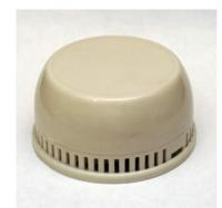
характер звука — чередующийся двухтональный сигнал. Источник звука - пьезосирена. Включение звонка осуществляется подачей напряжения на клеммные колодки электронной схемы. Конструктивно звонок выполнен в виде одного блока со съёмной крышкой, закрывающей доступ к электронной плате с колодками внешних подключений и элементами креплений. Конструкция звонка позволяет производить его разборку с последующей сборкой. Изделие ремонтопригодно.
