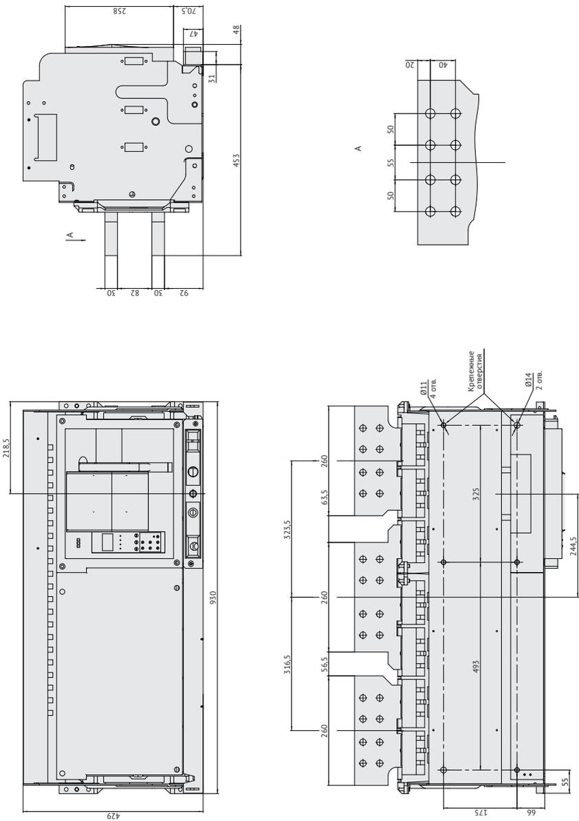
**Рисунок А.10** – Автоматический выключатель OptiMat А-6300-S6 выдвигного исполнения на номинальный ток 6300 А
