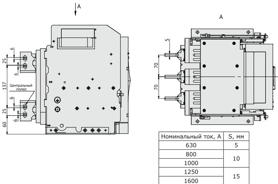
**Рисунок А.7** – Автоматический выключатель OptiMat A-630-1600-S1 выдвигного исполнения на номинальные токи 630 – 1600 А с вертикальным расположением выводов
