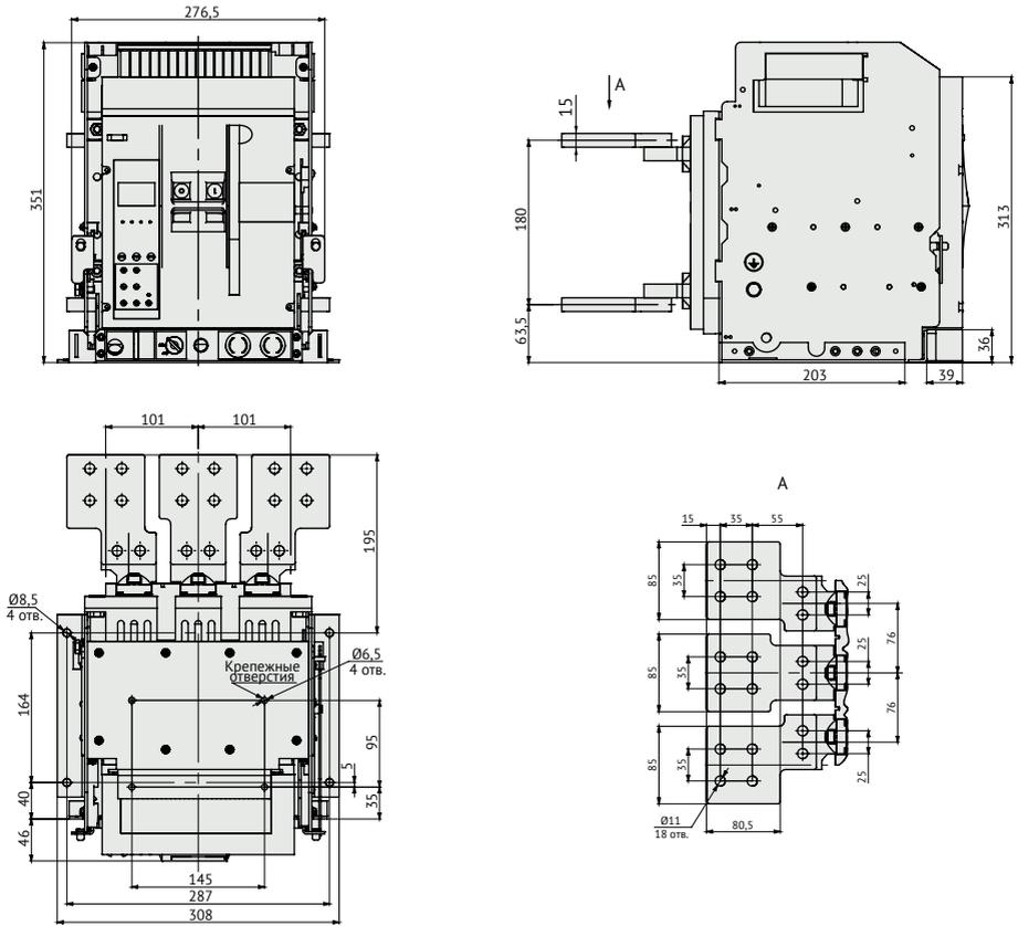
**Рисунок А.6** - Автоматический выключатель OptiMat A-1600-S1 выдвижного исполнения на номинальный ток 1600 А с горизонтальным расположением выводов с установленными расширителями полюсов
