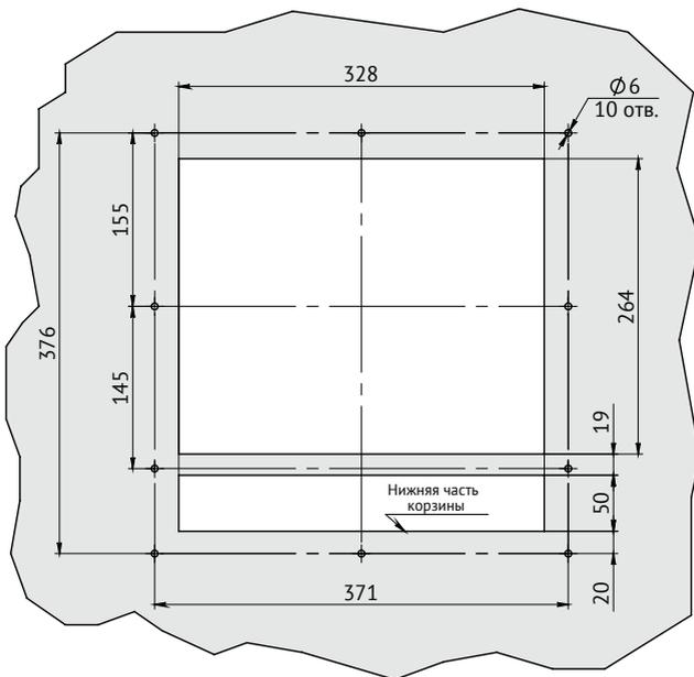
**Рисунок А.11** – Вырез в дверце для автоматического выключателя OptiMat А-5000-S5, OptiMat А-6300-S6 выдвигного исполнения
