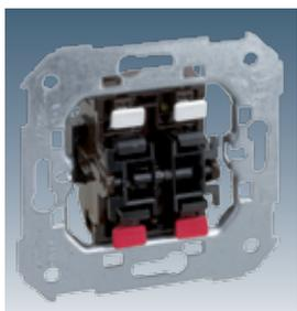
75396 -39 Двухклавишный кнопочный выключатель (2вх+2вых) используется для управления работой жалюзи 10 А / 250 В~ без блокировки
