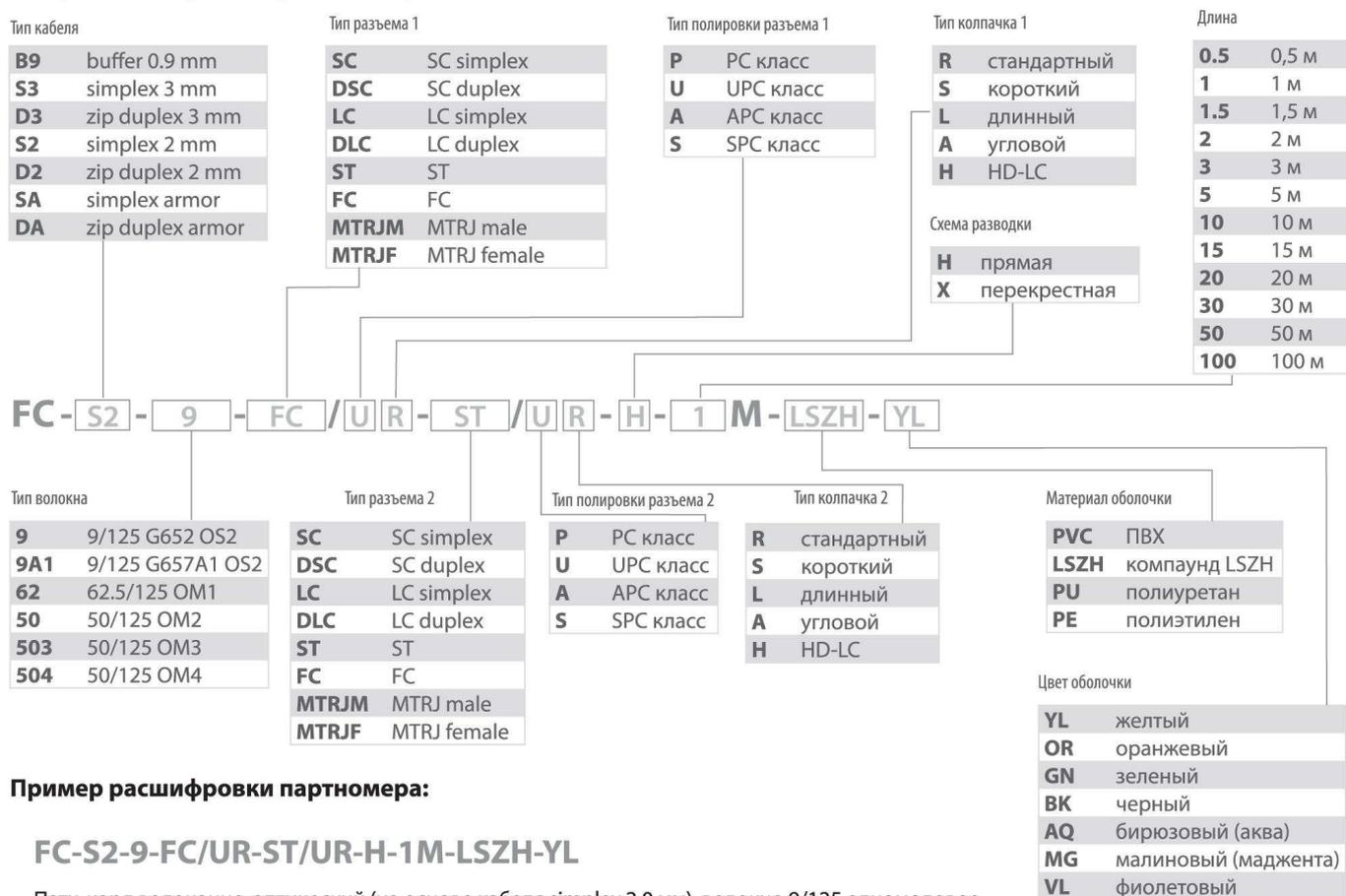
Патч-корд волоконно-оптический (на основе кабеля simplex 2,0 мм), волокно 9/125 одномодовое (OS2), разъем на 1-ом конце кабеля FC (полировка UPC, стандартный), разъем на 2-ом конце кабеля ST (полировка UPC, стандартный), длина 1 м, оболочка LSZH, цвет желтый
