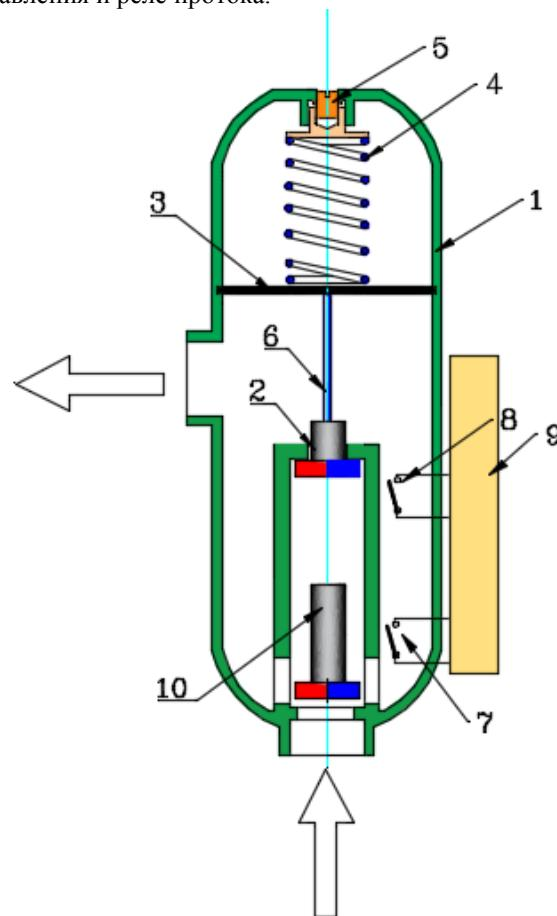
В корпусе (1) свободно перемещается в вертикальном направлении втулка расхода с магнитом (10). Когда водоразбора нет, втулка под действием собственного веса опускается, размыкая контакты геркона (7). При наличии протока втулка поднимается, замыкая контакты геркона (7). Мембра (3) уравновешена давлением жидкости (снизу) и силой упругости пружины (4) (сверху). Мембра (3) посредством штока (6) жестко связана с втулкой давления (2), в которую интегрирован постоянный магнит. Когда давление жидкости
